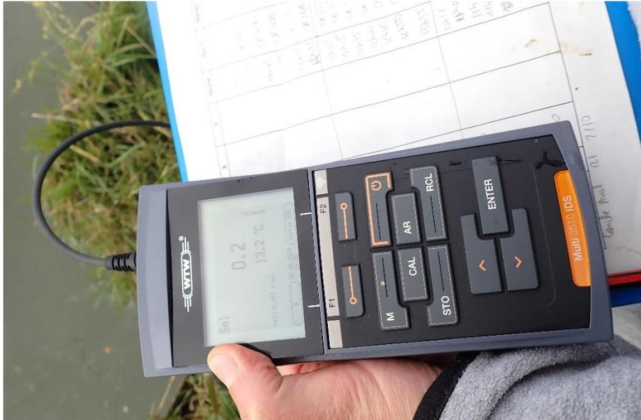
Figure 69 : Relève des paramètres environnementaux à l'aide de la sonde sur la Canche
