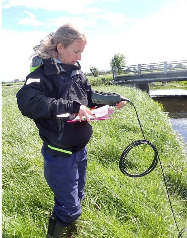
Figure 74 : Relève des paramètres environnementaux à l'aide de la sonde sur le Canal de Retz
