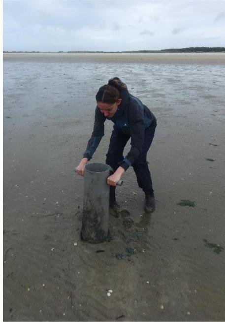
*Figure 2 : Prélèvement de scrobiculaires par carottage.*
