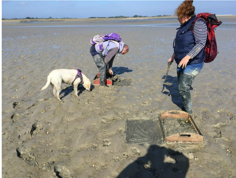
Figure 2 : Prélèvements de terrain à l'aide d'une veinette modifiée (outil de travail des pêcheurs à pied de coques professionnels, sur laquelle un tamis d'1 cm de maille est installé)
