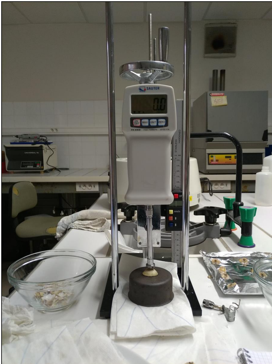
Figure 4 : Montage du dynamomètre utilisé pour l'expérience de compression d'une valve de coque
