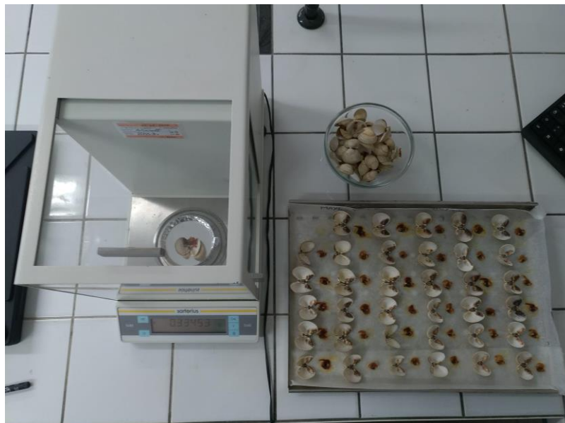
Figure 6 : Pesées de la chair et de la coquille des coques après étuvage et mesure pour calculer l'indice de condition de Walne et Mann
