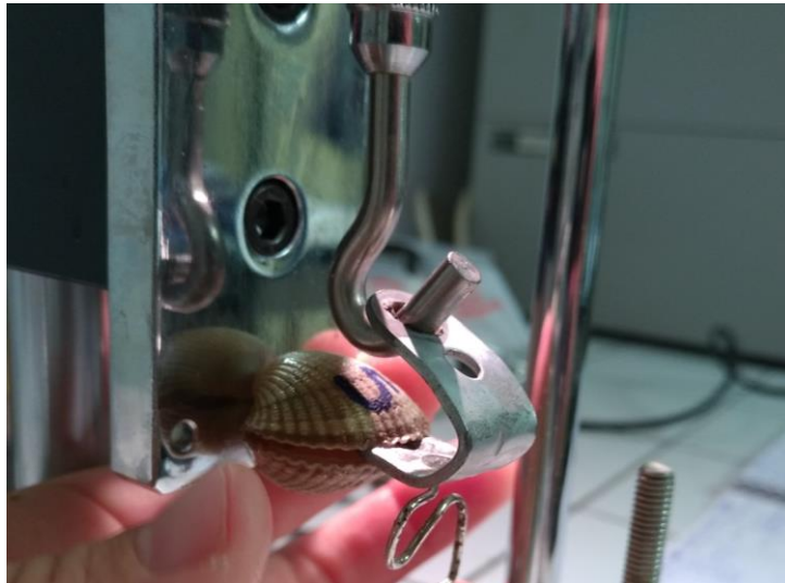
Figure 5 : Montage d'une coque sur les crochets nécessaires au test d'étirement des muscles
