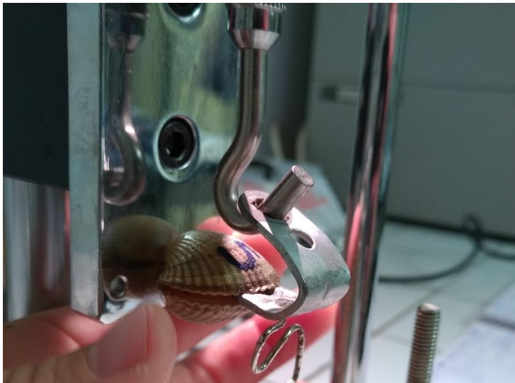
Figure 22 : Montage d'une coque sur les crochets nécessaires au test d'étirement des muscles ©GEMEL
