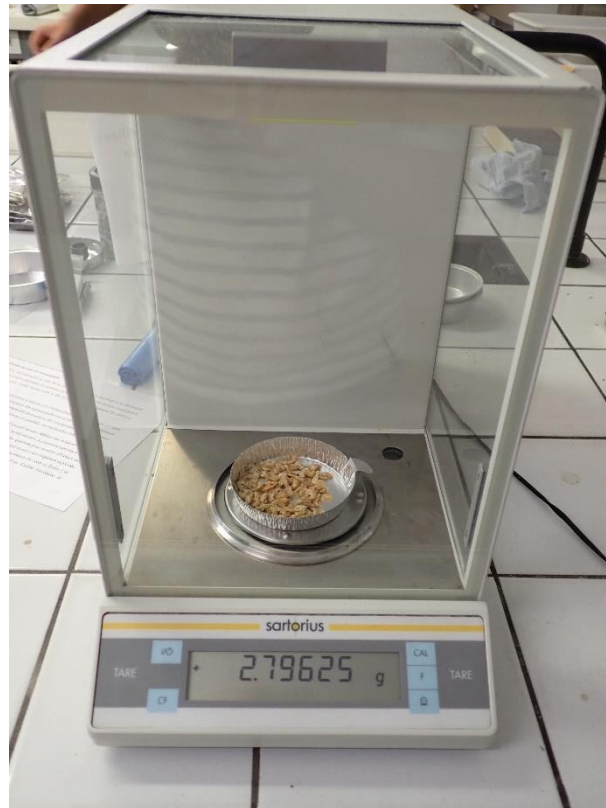
Figure 26 : Pesée d'un réplikat d'amphipodes sur la balance de précision après passage à l'étuve (© GEMEL)
