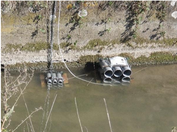
Pièges condo pour capturer les crabes chinois sur le canal à poissons amont
