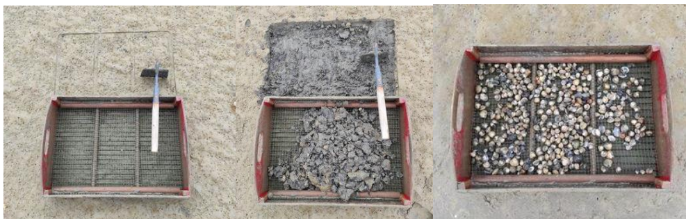
Figure 4 : Cribles utilisés pour les prélèvements de terrain (à gauche ; = outil de travail des pêcheurs à pied de coques professionnels, sur lequel un tamis d'1 cm de vide de maille est installé), prélèvement du sédiment (au milieu), refus de tamis (à droite)
