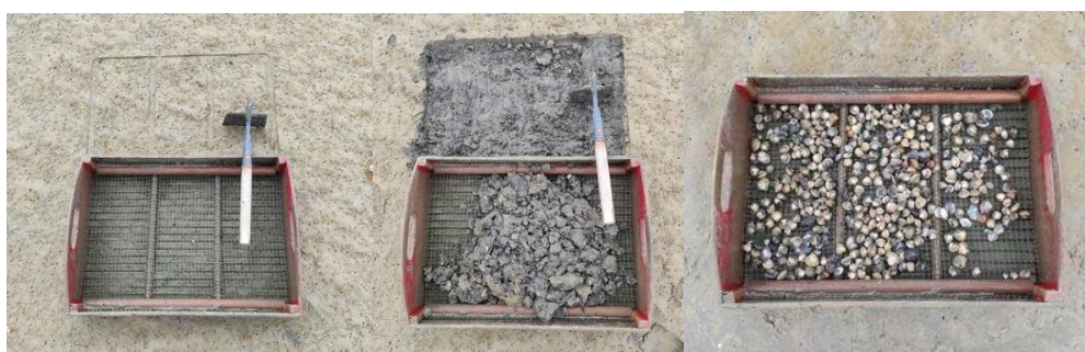
Figure 1 : Cribles utilisés pour les prélèvements de terrain (à gauche ; = outil de travail des pêcheurs à pied de coques professionnels, sur lequel un tamis d'1 cm de vide de maille est installé), prélèvement du sédiment (au milieu), refus de tamis (à droite)
