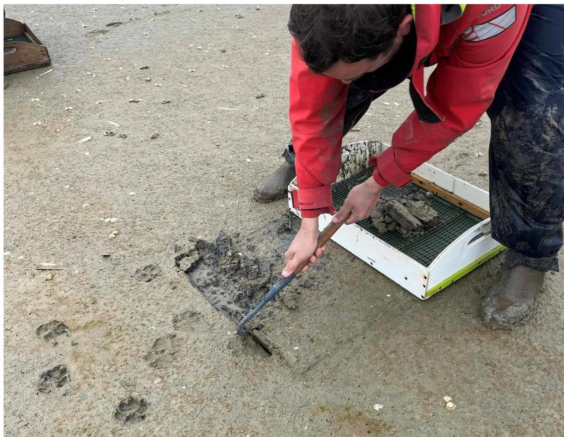
Figure 3 : Prélèvements de terrain à l'aide d'une veinette modifiée (outil de travail des pêcheurs à pied de coques professionnels, sur laquelle un tamis d'1 cm de maille est installé)
