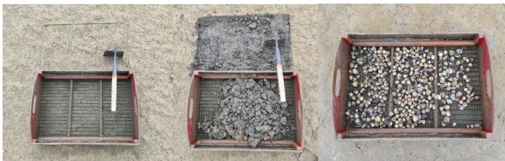
Figure 2 : Cribles utilisés pour les prélèvements de terrain (à gauche ; = outil de travail des pêcheurs à pied de coques professionnels, sur lequel un tamis d'1 cm de vide de maille est installé), prélèvement du sédiment (au milieu), refus de tamis (à droite)
